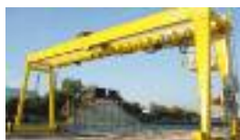
Pont roulant contrôle tous les ans
