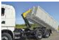
Bras de levage contrôle tous les 6 mois
